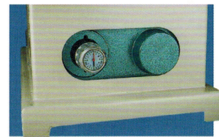
無段變速送料： 速度範圍 4-13米/分 Variable feed speed change: Range from 4-13m/min
